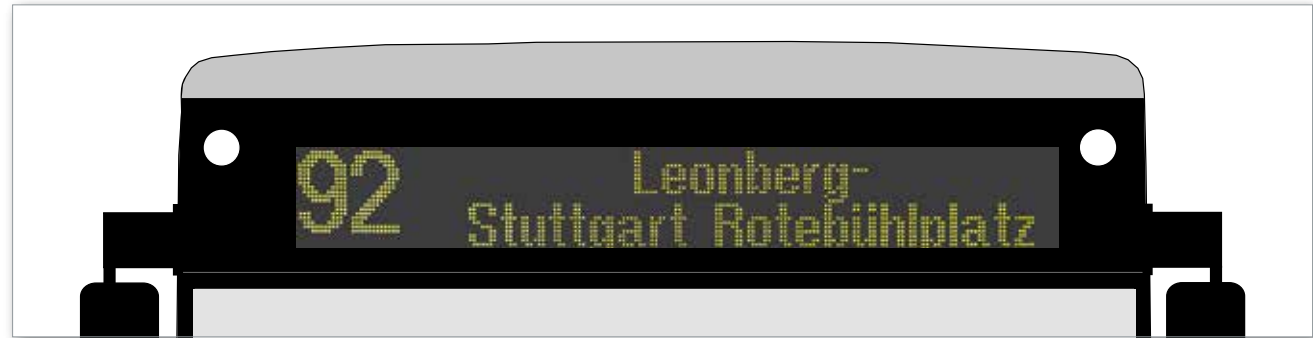
Fahrtzielanzeiger vorne Liniennummer, Linienverlauf, Fahrtziel
