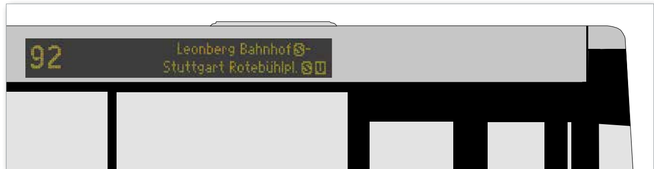
Fahrtzielanzeiger seitlich, rechts Liniennummer, Linienverlauf, Fahrtziel
